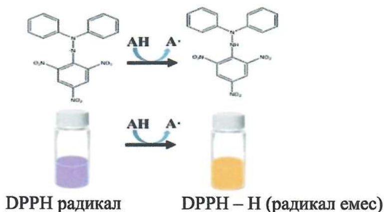
Сурет 7 – Антиоксидантпен тотықсызданғаннан кейін DPPH радикалының химиялық құрылымы мен түсінің өзгеруі
